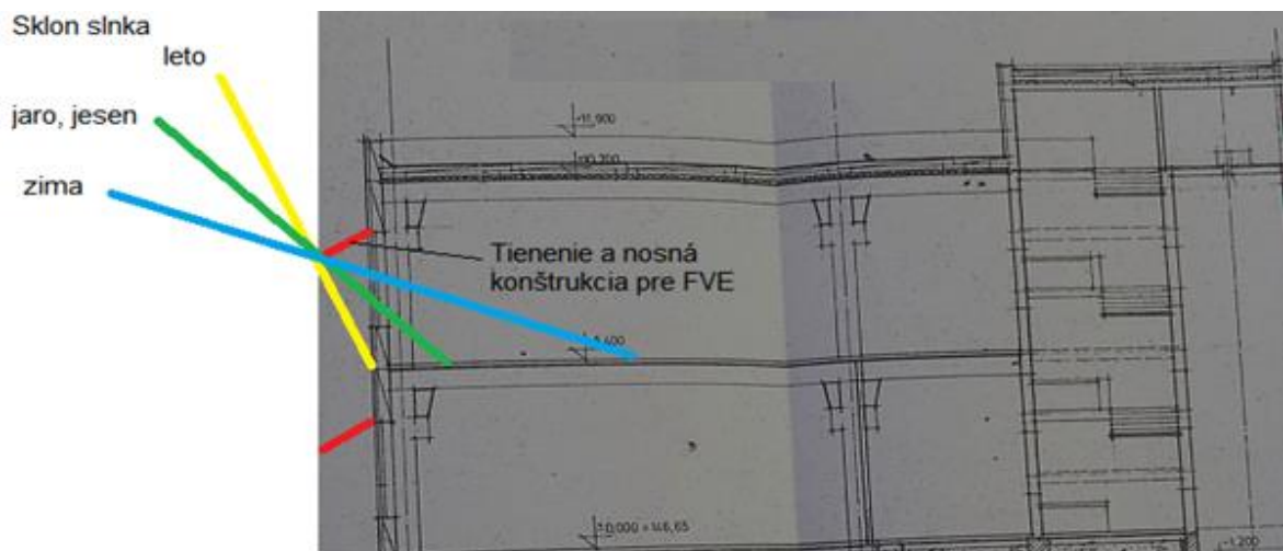
Obrázok 43: Tienenie okien a nosná konštrukcia FVE
