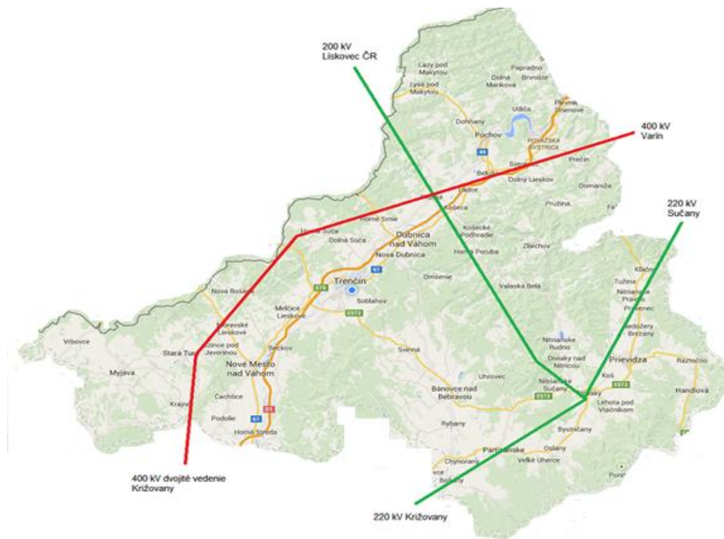
Obrázok 10: Nadradené energetické trasy VVN v TSK
